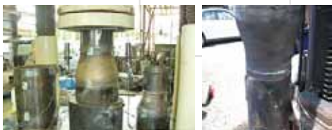
■ 拡頭杭性能試験
