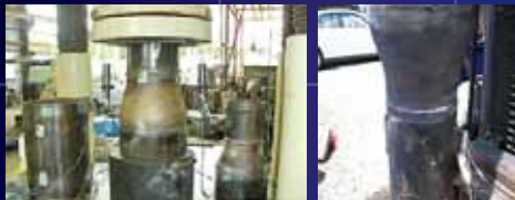
■拡頭杭性能試験
