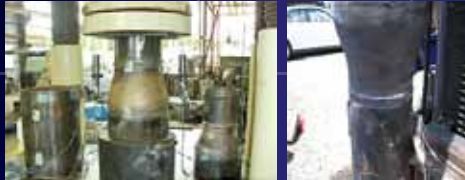
■拡頭杭性能試験
